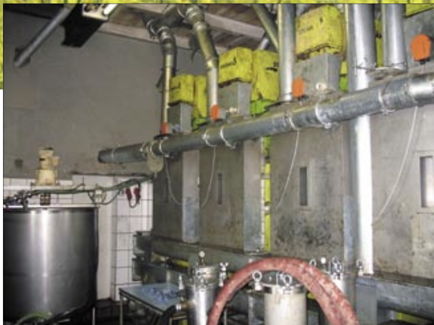
Die vier Rapsölpresen laufen rund um die Uhr. Dabei erzeugen sie 6.000 Liter kalt gepresstes Pflanzenöl am Tag.
