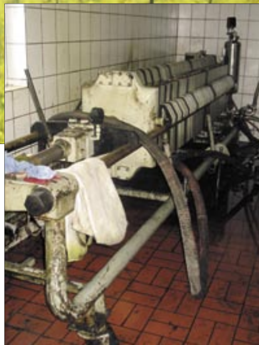
Die Filteranlage. Alle zwei Tage werden die Filter gewechselt.
